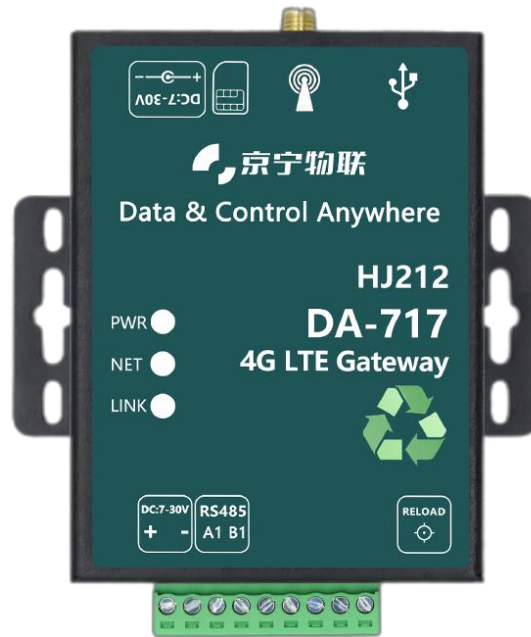
图 3 环保网关实物图
